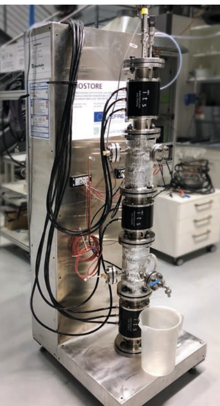
ERT-Versuchsstand zur Charakterisierung des Begasungszustands in Blasensäulenreaktoren.
